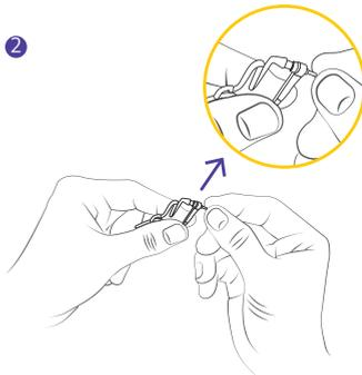
To separate the blade and mini hand driver, press the mini hand driver on blue button
